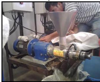
*Máquina para la producción de biocombustibles líquidos extraídos de Jatropha Curcas para la producción de electricidad*
